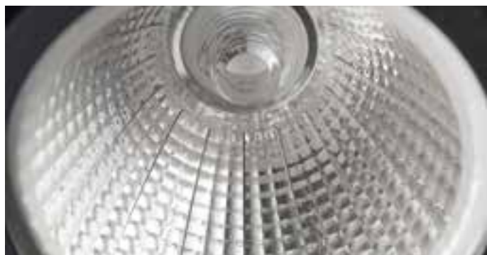
Die innovativen LED-Hybridoptiken der Intara CX Richtstrahler vereinen die Vorteile von Reflektor- und Linsensystemen und erzeugen einen besonders ausgewogenen Kontrast zwischen dem Schwerpunkt und dem Hof des Lichtkegels.
