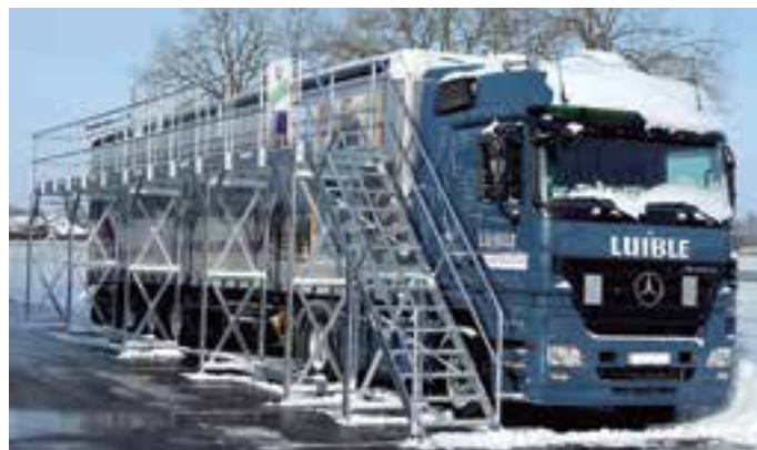
Verbindet Verkehrssicherheit mit Arbeitssicherheit: Das Enteisungsgerüst der Günzburger Steigtechnik zur Enteisung von Lkw und Nutzfahrzeugen.
